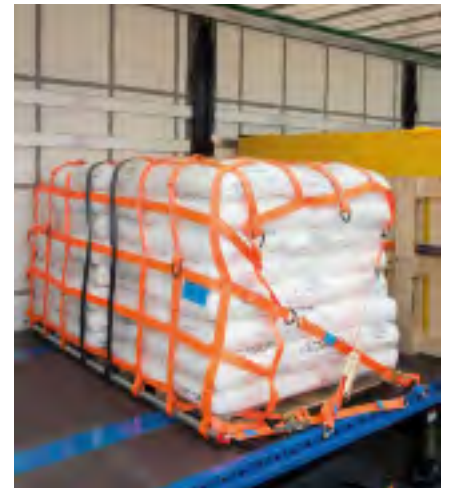
Netz mit Kopflashing
