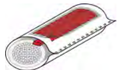
Ausreißfestes Label mit RFID-Transponder
