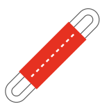
Abb. 3 mit Mittelnaht für Rundschnur über Doppelstrang
